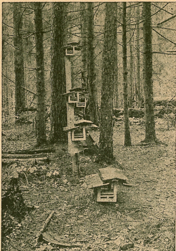
Obr. 2. Snaha po lepším vystižení mikroklimatických podmínek, než je možno pomocí jediného měřistiště ve standardní výšce, vedla k umístování přístrojů v různých výškách nad povrchem půdy v přízemní vrstvě ovzduší. Nejde-li o sledování jemných rozdílů a používá-li se běžných meteorologických měřicích přístrojů, užívá se ještě dosti často meteorologických budek, obvykle různě upravených. Na snímku lesnická mikroklimatická stanice v polské Białowieži, pracující s upravenými budkami v několika úrovních přízemní vrstvy porostního ovzduší. Foto Ing. Moutl.
